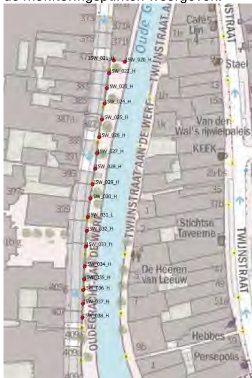
Figuur 2: locaties prisma's aan werfmuur rak 15
